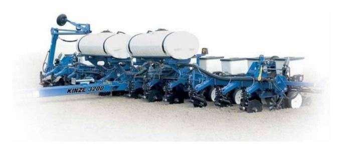
Сеялка предназначена для пунктирного высева калиброванных и некалиброванных семян кукурузы, подсолнечника, сои с одновременным внесением жидких удобрений (опционально).
